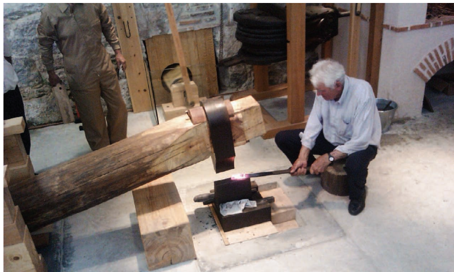
FIG. 4 Funcionamiento de un martinete o mazo.
